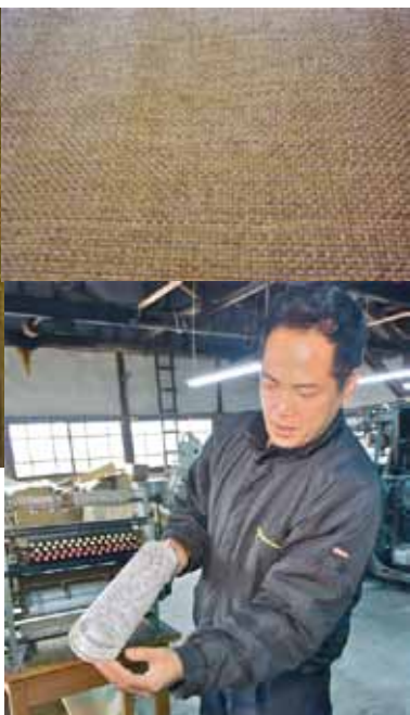
織機での織り方を変えるためのプログラムは、今でもロールを一つ一つパンチで打ち抜いたもので、複雑な織りになるほど、大変な作業。それでも曾祖父の時代には、複雑な織目を実現しており、久人さんはその復元にも力を注ぐ。
